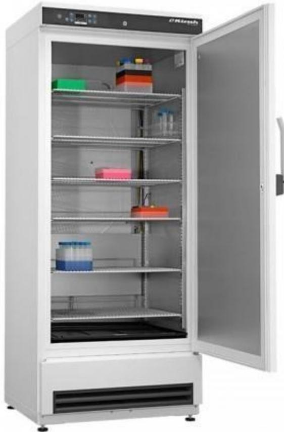
Этот лабораторный холодильник оснащен 6 полками покрытыми пластиком и регулируемые по высоте. Помимо этого стандартная комплектация включает систему взрывобезопасности внутренних деталей. За дополнительную плату возможен заказ стеклянной дверцы, пластиковых ящиков с продольными и поперечными ячейками, а так же алюминиевых подносов на телескопических направляющих.
